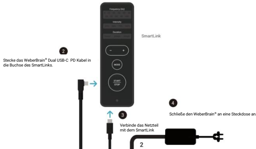
Grafik 6: Verbindung zwischen SmartLink und Stromversorgung
